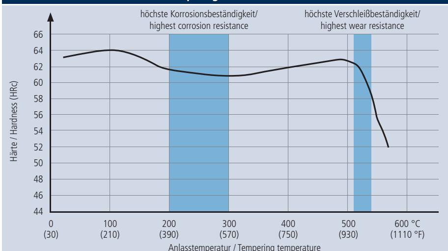
Vakuumhärten: 1150 °C / 30 min / N<sub>2</sub>, 5 bar
