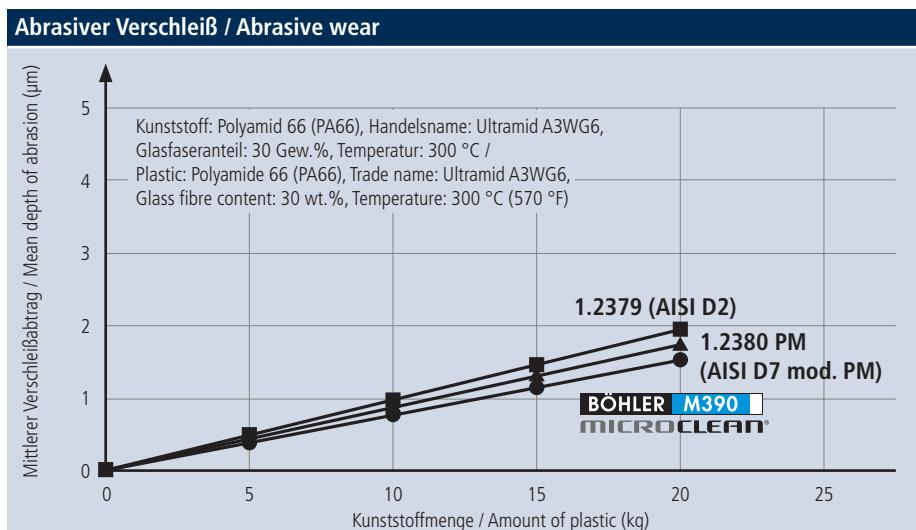
Sowohl bei der Verspritzung von rein abrasiv wirkendem PA66 mit 30% Glasfaseranteil bei 300 °C, als auch bei der Verspritzung von abrasiv und korrosiv wirkendem PES mit 30% Glasfaseranteil bei 400 °C weist M390 MICROCLEAN die beste Verschleiß- und Korrosionsbeständigkeit auf. Durch die Bildung korrosiv wirkender schwefeliger Abbauprodukte bei der Verarbeitung von PES nimmt der Verschleiß bei 1.2379 und 1.2380PM um 250% bzw. 200% zu.
