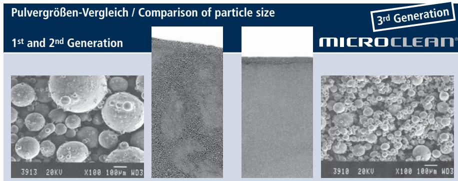
Die Herstellung feinen Pulvers mit einem höheren Reinheitsgrad ist Voraussetzung für die Erfüllung der vorgenannten Werkstoffeigenschaftsverbesserungen.
