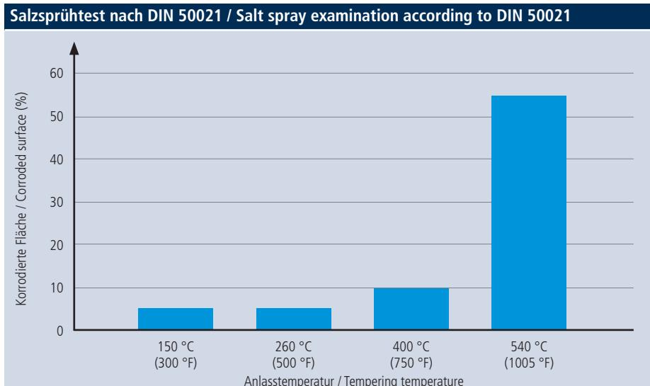
Für höchste Korrosionsbeständigkeit niedrige Anlasstemperaturen verwenden. Tiefkühlen sollte vorgesehen werden.
