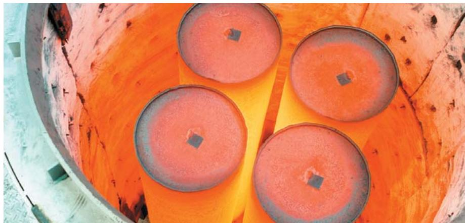
Dieses Pulver wird in einem Diffusionsprozess (HIP) unter Druck und Temperatur zu einem homogenen, seigerungsfreien Hochleistungsstahl mit praktisch isotropen Eigenschaften verdichtet.
